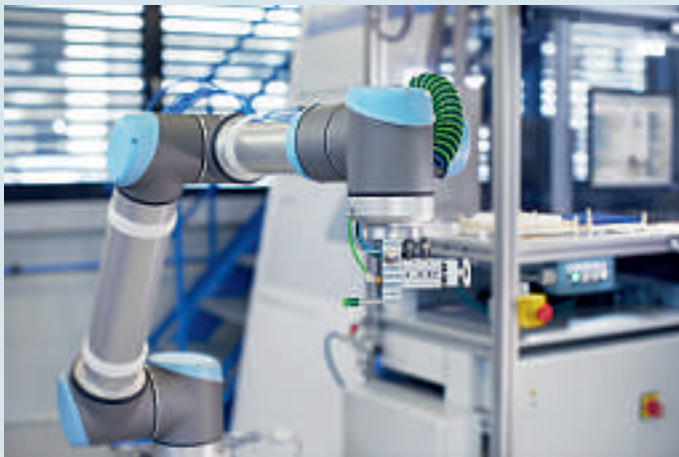
Für die Werksabnahme werden in der Werkstatt in Pruntrut Roboterzellen mit Peripheriesystemen wie zum Beispiel Zuführsystemen aufgebaut und getestet. (Bilder: JAG)
