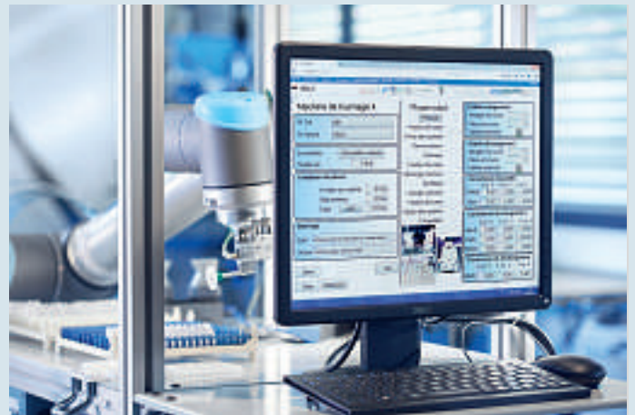
Das webbasierte Produktionsführungssystem WebFPS unterstützt die Bedienung und Überwachung und verwaltet die Artikel und Parameter für die Robotersteuerung.
